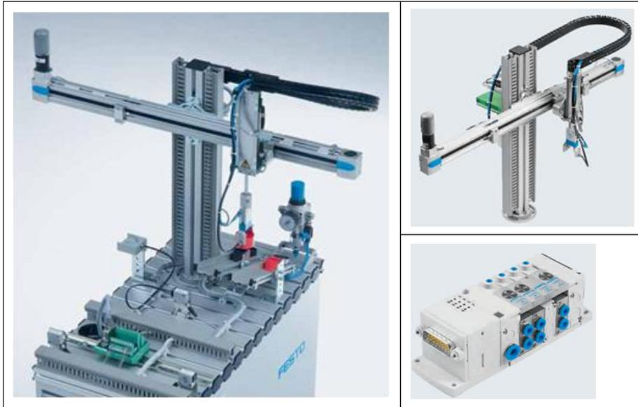
(2)电操作手单元功能：电操作手单元配备一个柔性的二轴抓手。在托盘上的工件被漫射传感器检测到，气抓手抓起工件，抓手上的光电传感器检测“黑色”或“非黑色”工件。工件被放置到不同的滑槽内。如果和其它单元组合，工件可以被传输到下游单元。
