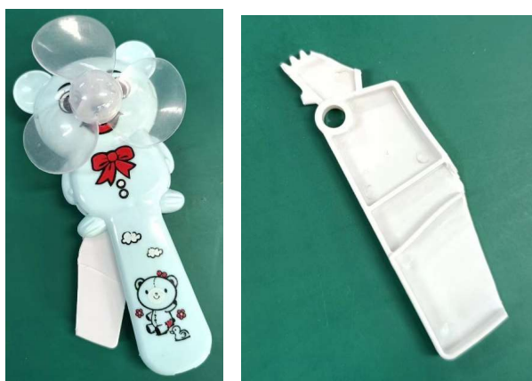
图 1 手压风扇及破损盖板
